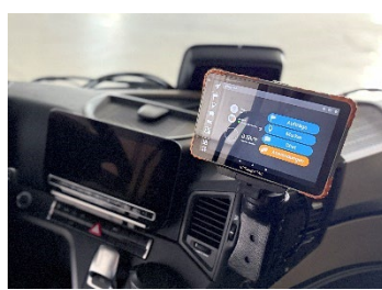
Abb. 03b: Detailaufnahme des GPSauge TAB – sturz- und stoßsicheres 8-Zoll Tablet mit Industriegehäuse
